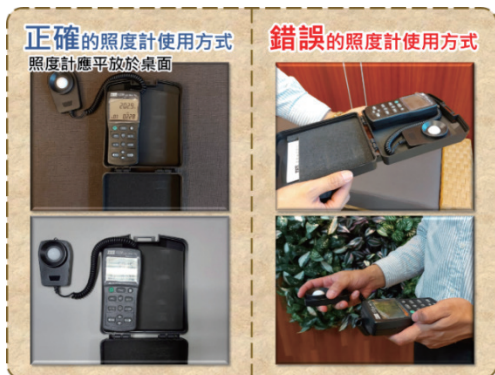
圖 9 照度量測方法
