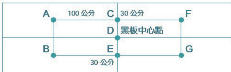
圖 10 黑板照度量測方法
