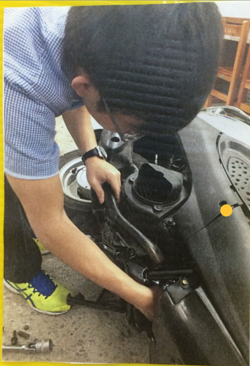
拆裝煞車來令片的過程
