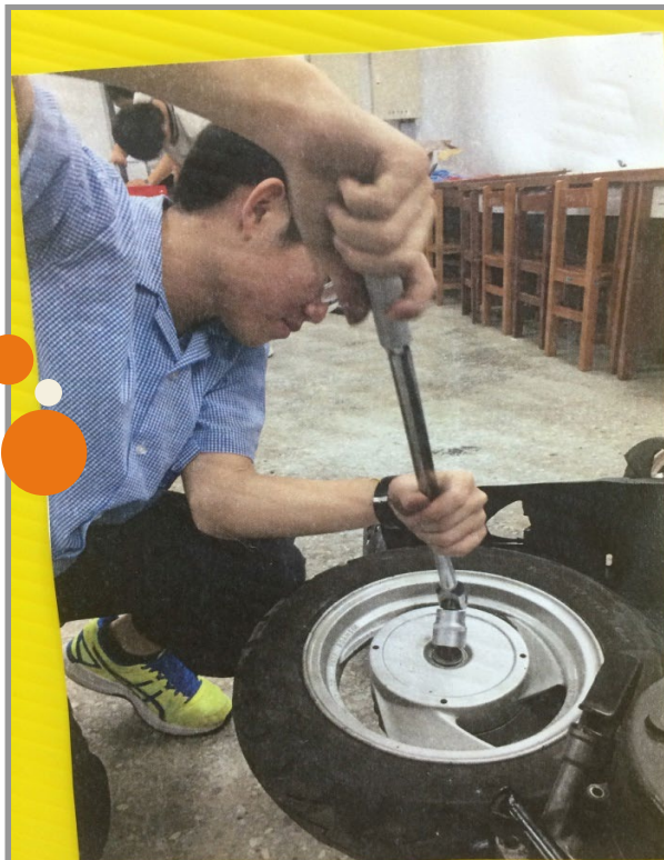
拆裝煞車來令片的過程
